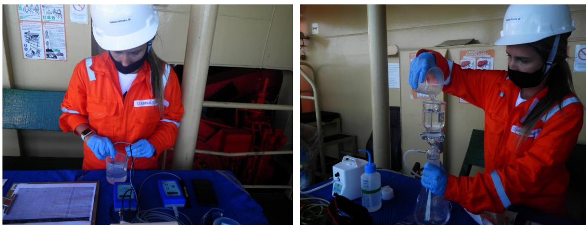
Figura 7: Equipamentos utilizados na medição dos parâmetros físico-químicos in situ e na filtração durante a 18ª Campanha do Projeto de Monitoramento Ambiental nos Campos de Bijupirá & Salema.
