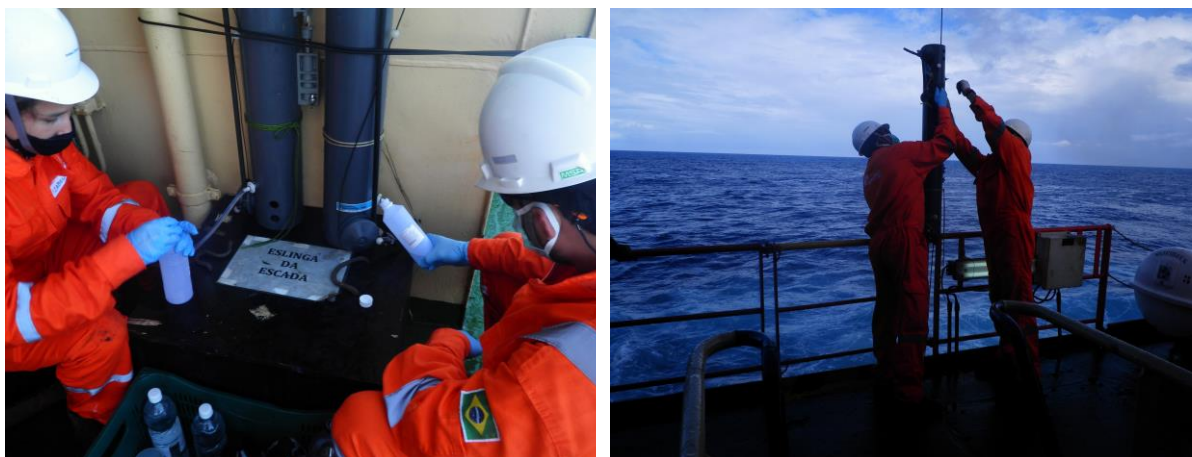
Figura 6: Lançamento de garrafa oceanográfica (GO-FLO) durante a 18ª Campanha do Projeto de Monitoramento Ambiental nos Campos de Bijupirá & Salema.
